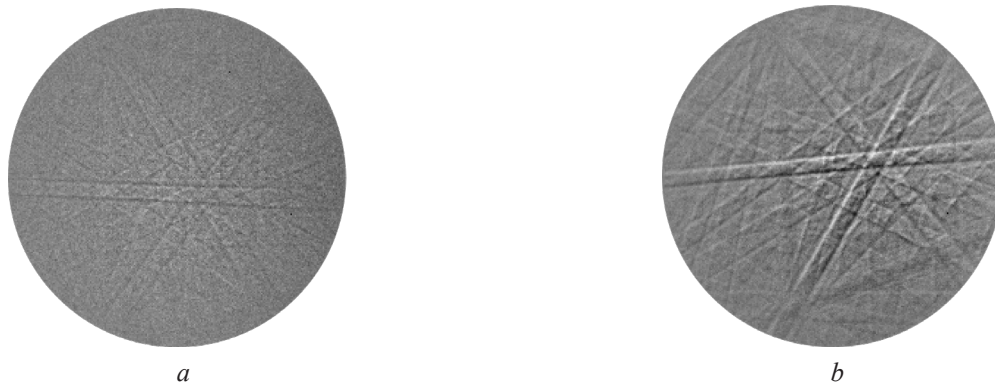
Рисунок 1 – Картины дифракции обратно отражённых электронов от поверхности: a – исходных кремниевых пластин; b – после быстрой термообработки
