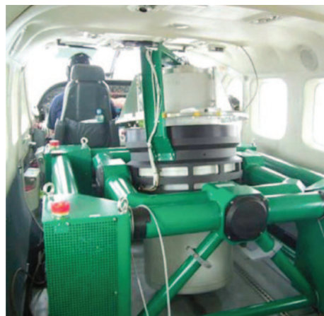
Рисунок 10 – Сосуд Дьюара с жидким гелием и прибором VK1 установлен на стабилизированной платформе, которая вмонтирована в кабину самолета Cessna 208 [49]
