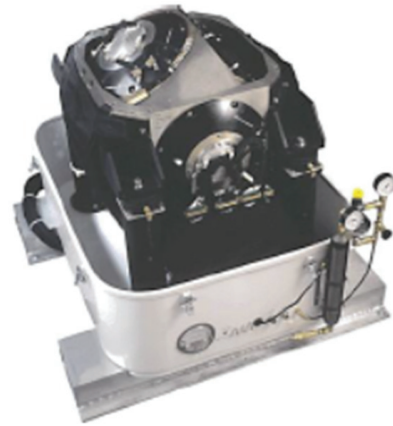
Рисунок 4 – Сборка всех трех дисков в кардановом подвесе прибора Air-FTG [29, 61]
