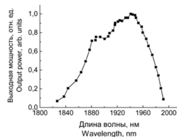
Рисунок 7 – Перестроечная кривая лазера на кристалле Tm:KLuW
