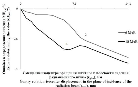
**Рисунок 3** – Зависимость ошибки в определении опорного значения дозы линейного ускорителя от смещения изоцентра вращения штатива в плоскости падения радиационного пучка для фотонов с энергиями 18 МэВ (1) и 6 МэВ (2)
