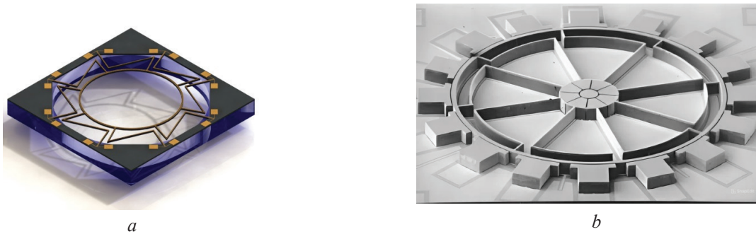
Рисунок 1 – Волновые твердотельные гироскопы, выполненные по технологии МЭМС, с наружным (а) [8] и внутренним (b) упругим подвесом [9]
