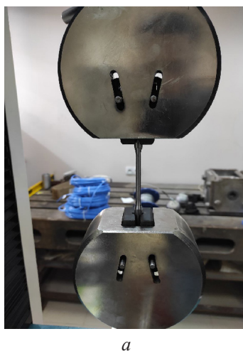
Рисунок 4 – Испытание образца в разрывной машине (a), размеры образца (b)
