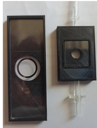
Рисунок 3 – Слева – лоток для предметного стекла, справа – проточная кювета
