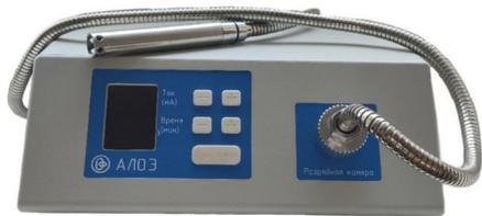
**Рисунок 1** – Фотография аппарата для генерации воздушной плазменной струи «АЛОЭ»
