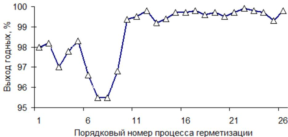
Рисунок 6 – Выход годных по герметичности интегральных схем при герметизации сварочным током 80–95 А (процессы 1–10) и сварочным током 60–80 А (процессы 11–26)
