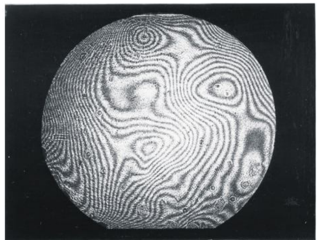
Рисунок 3 – Интерферограмма пластины, имеющей несферическую форму изгиба
