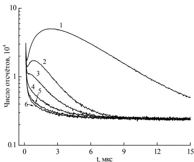
Рисунок 6 – Кинетики фотосенсибилизированной 5, 10, 15, 20-тетракис (4-N-метилпиридил) порфирином фосфоресценции синглетного кислорода на длине волны 1272 нм при добавлении в водный раствор азид натрия: 1 – без тушителя; 2 – 6 добавлен  $\text{NaN}_3$  в концентрациях: 2 – 2,5 мМ, 3 – 5 мМ, 4 – 12,5 мМ, 5 – 25 мМ, 6 – 40 мМ
