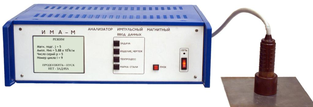
Рисунок 4 – Анализатор импульсный магнитный многопараметровый ИМА-М
